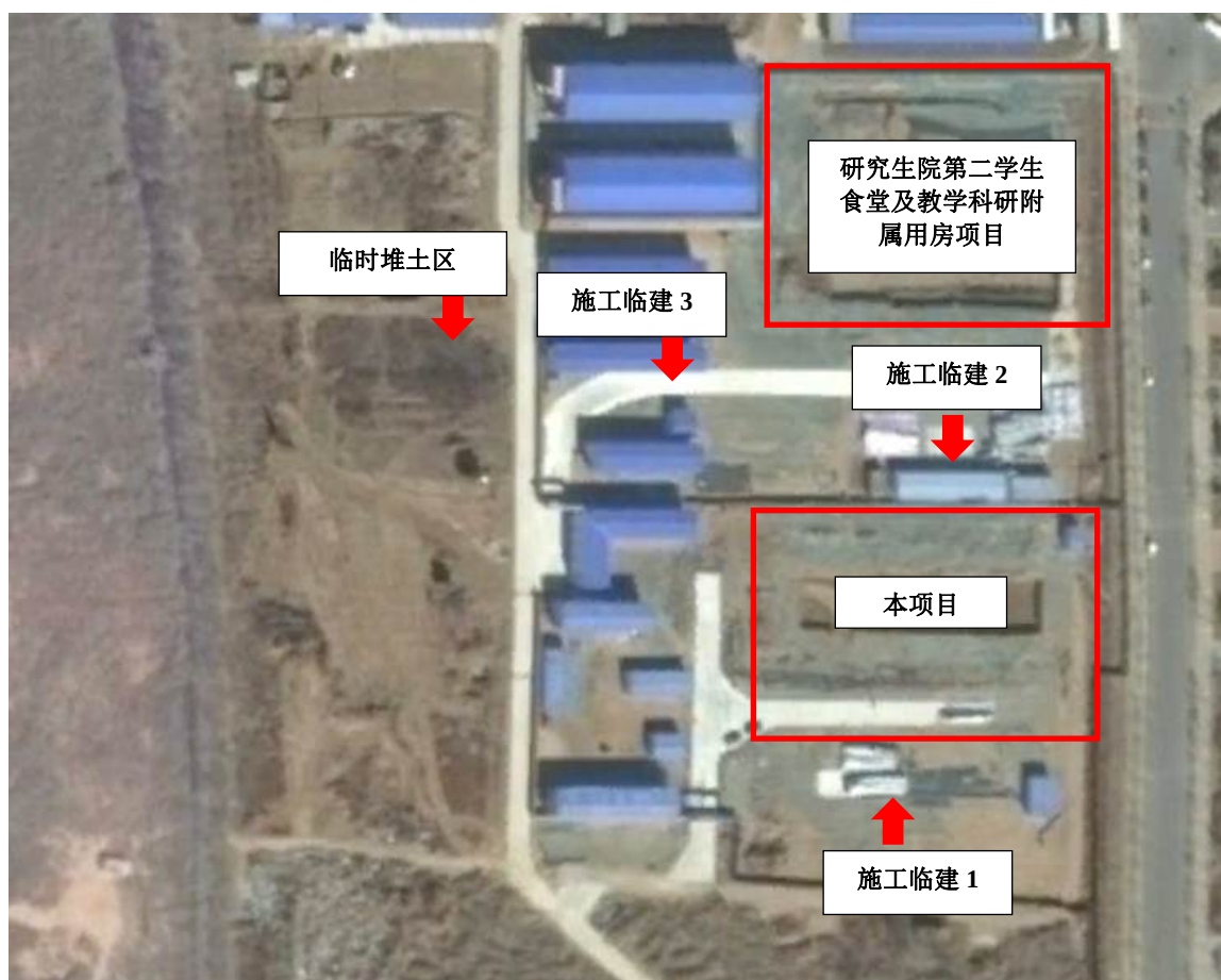
图 3-1 施工临建、临时堆土位置分布图
